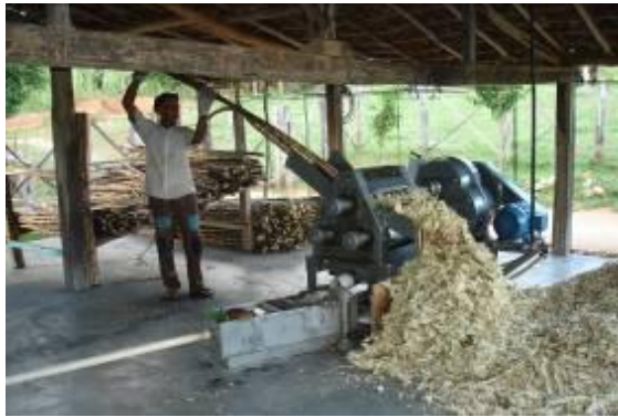
Figura 2. Moenda em funcionamento, com canas dispostas em local seco e suspenso.
